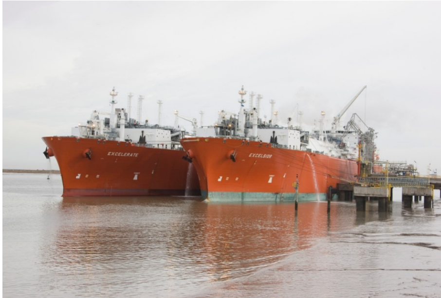
Figura 49: Navio Regaseificador (F.S.R.U) e navio supridor atracados no terminal de GNL de Baía Blanca (Argentina)
