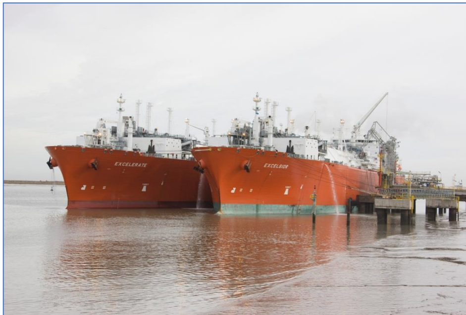
Figura 111: Navio Regaseificador (F.S.R.U) e navio supridor atracados no terminal de GNL de Baía Blanca (Argentina).
